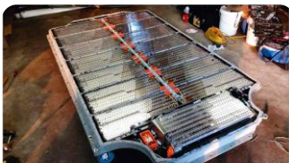
A Tesla Model S akkumulátorsomag a fedél eltávolítása után, 18650 cella, 85 kWh energiataralommal - Forrás: https://gizmodo.com/peek-inside-the-battery-of-a-tesla-model-s
