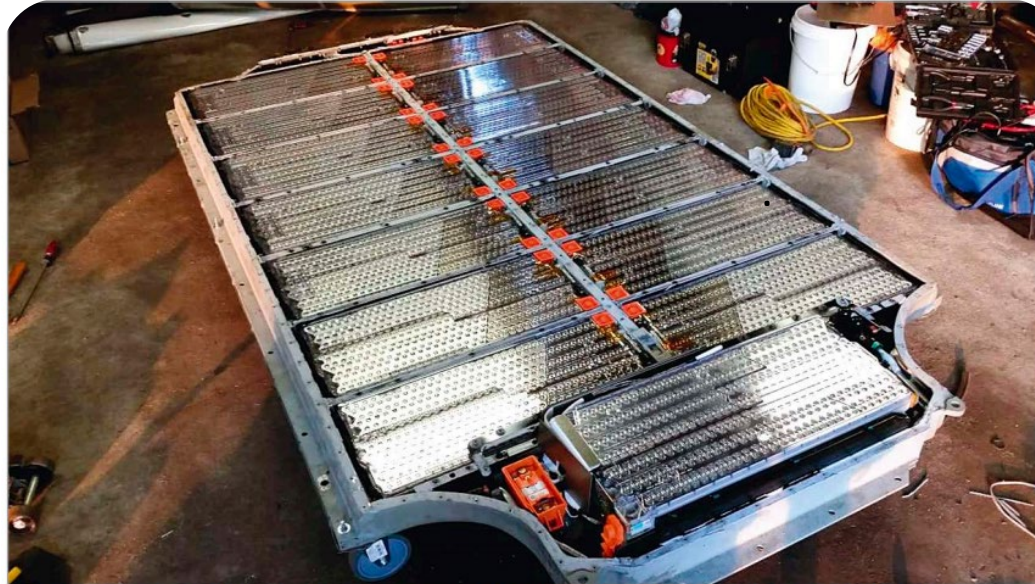
A Tesla Model S akkumulátorcsomag a fedél eltávolítása után, 18650 cella, 85 kWh energiataralommal – Forrás: https://qnov.com/peek-inside-the-battery-of-a-tesla-model-s
